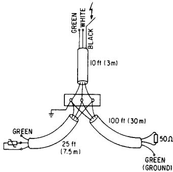
Fig. 3. Test circuit.
