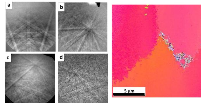
T-EBSD from thick foils. (a) 800 nm, (b) 1.5 μm, (c) 2 μm, and (d) 3 μm
