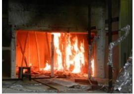
(d) exposed W1 at 85 min before 1<sup>st</sup> ply falling off
