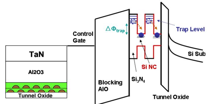
TaN/Al<sub>2</sub>O<sub>3</sub>/SiNC in SiN<sub>x</sub>/SiO<sub>2</sub>/Si sub
