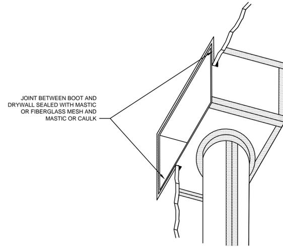
**WALL REGISTER AIR SEALING DETAIL**
