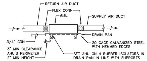
**AUXILIARY CONDENSATE DRAIN PAN DETAIL**
