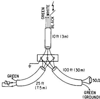
Fig. 3. Test circuit.
