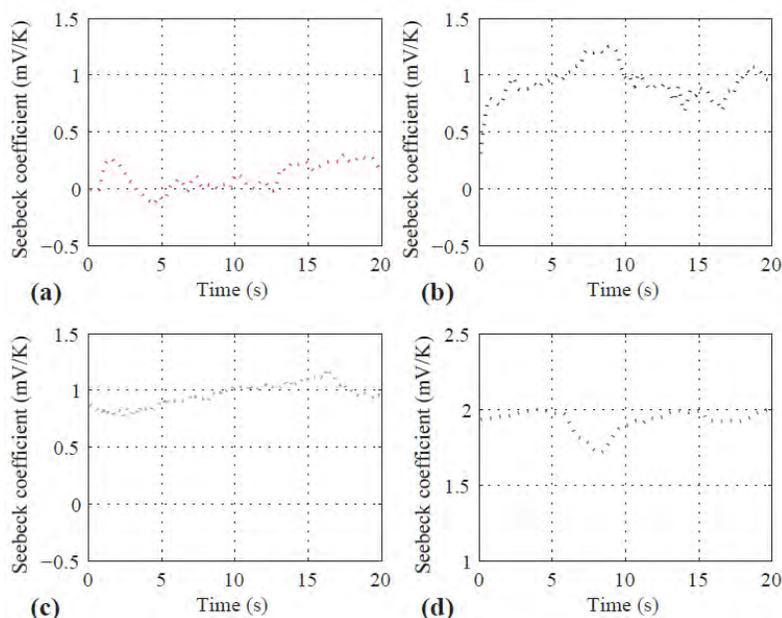
**FIGURE 2.** Seebeck Coefficient Measuring Results of (a) SiAg, (b) SiAg-15, (c) SiAg-30, and (d) SiAg-60.
