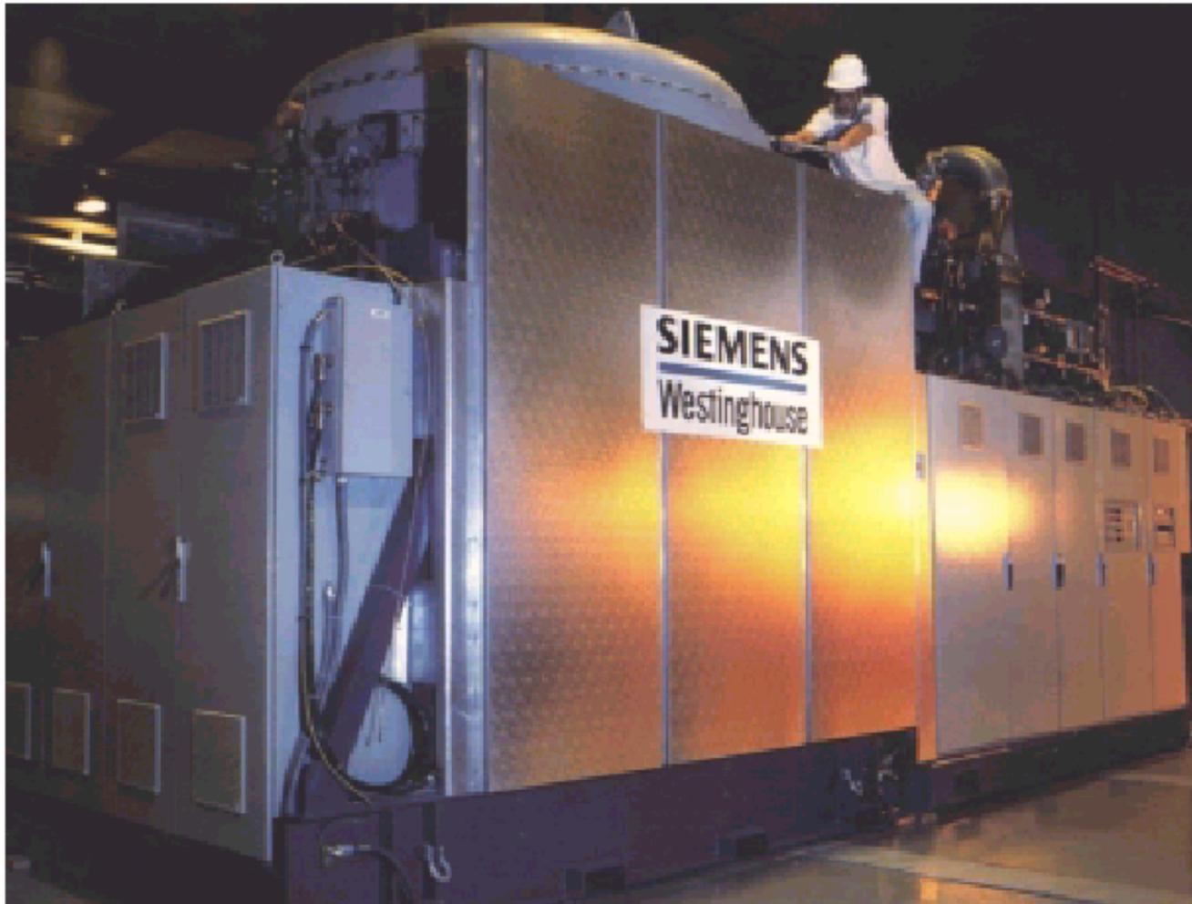
Figure 1. The SWPC 220 kW PSOFC/MTG
