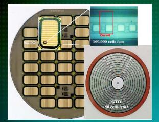
Basic Die (3.5 cm<sup>2</sup>) 20 kA, 6 kV 14 kA/µs, Turn-on Gain = 10<sup>6</sup>
