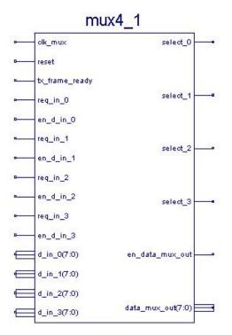
Figure 30: The mux4\_1 module.
