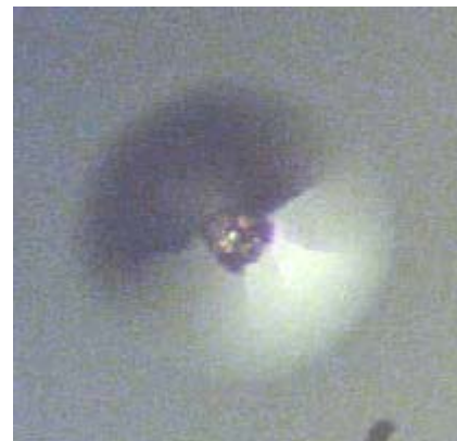
Nanoindent Adhesion Test (Delamination blister)
