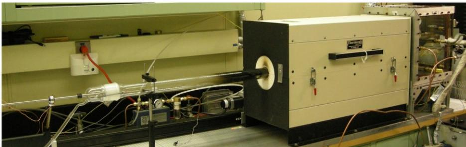
**FIGURE 2. ISO/TS 19700 Tube Furnace.**
